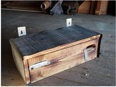
Fertiger Kasten mit Dachpappe und Verschlußklappen.
